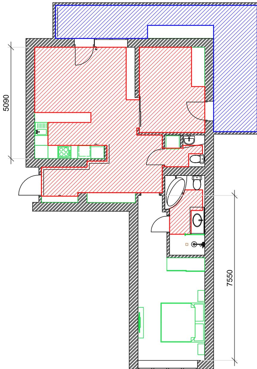
Площадь отопительной панели 63 кв.м.
