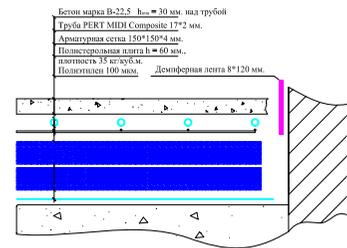
Примечание: Первый шаг трубы 75 мм. от чистой поверхности стен.
