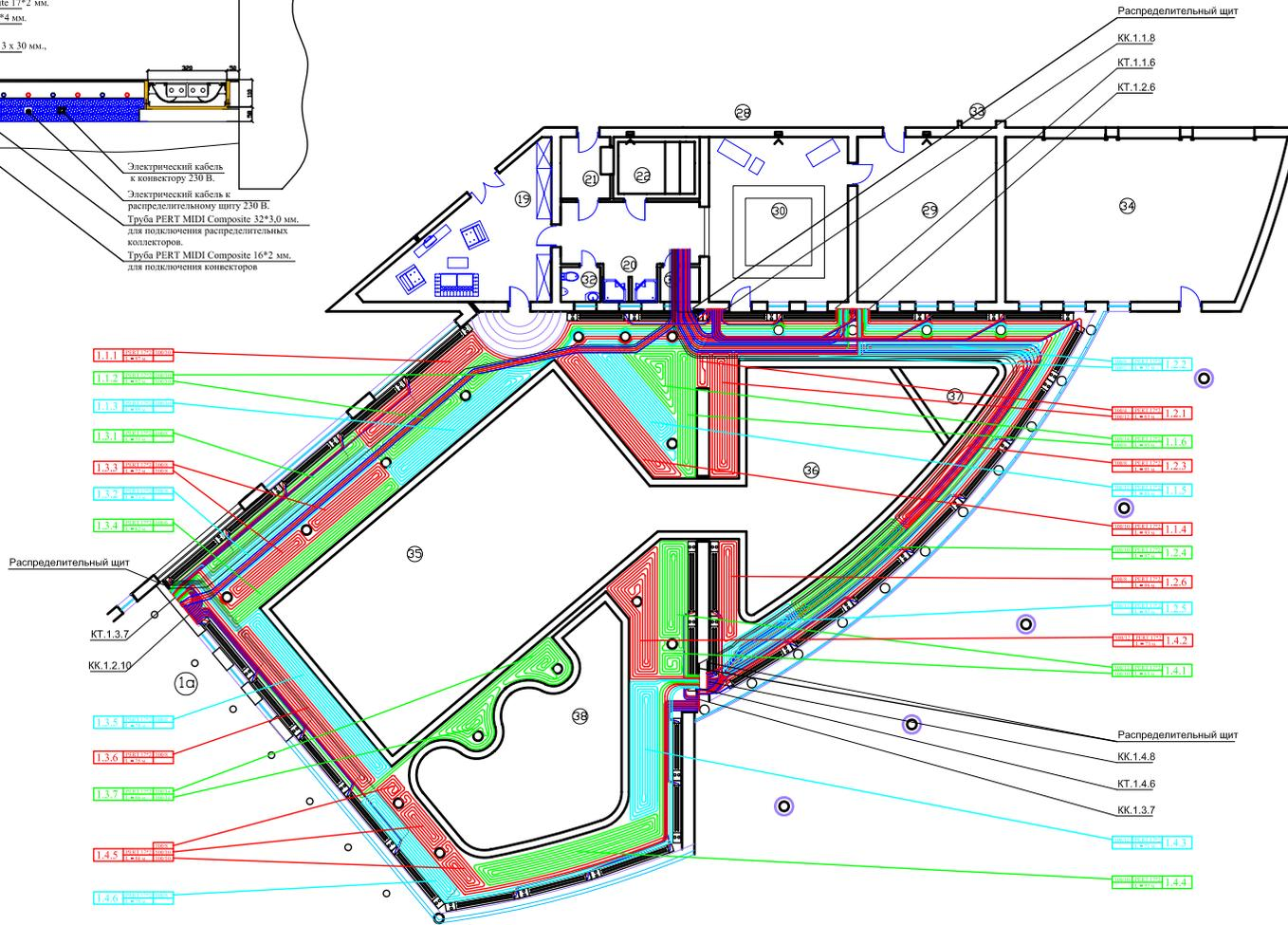
Примечание: Первый шаг трубы 75 мм. от чистовой поверхности стен.
