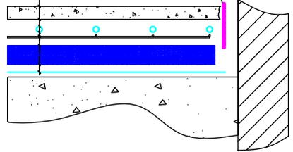
Примечание: Первый шаг трубы 75 мм. от чистой поверхности стен.
